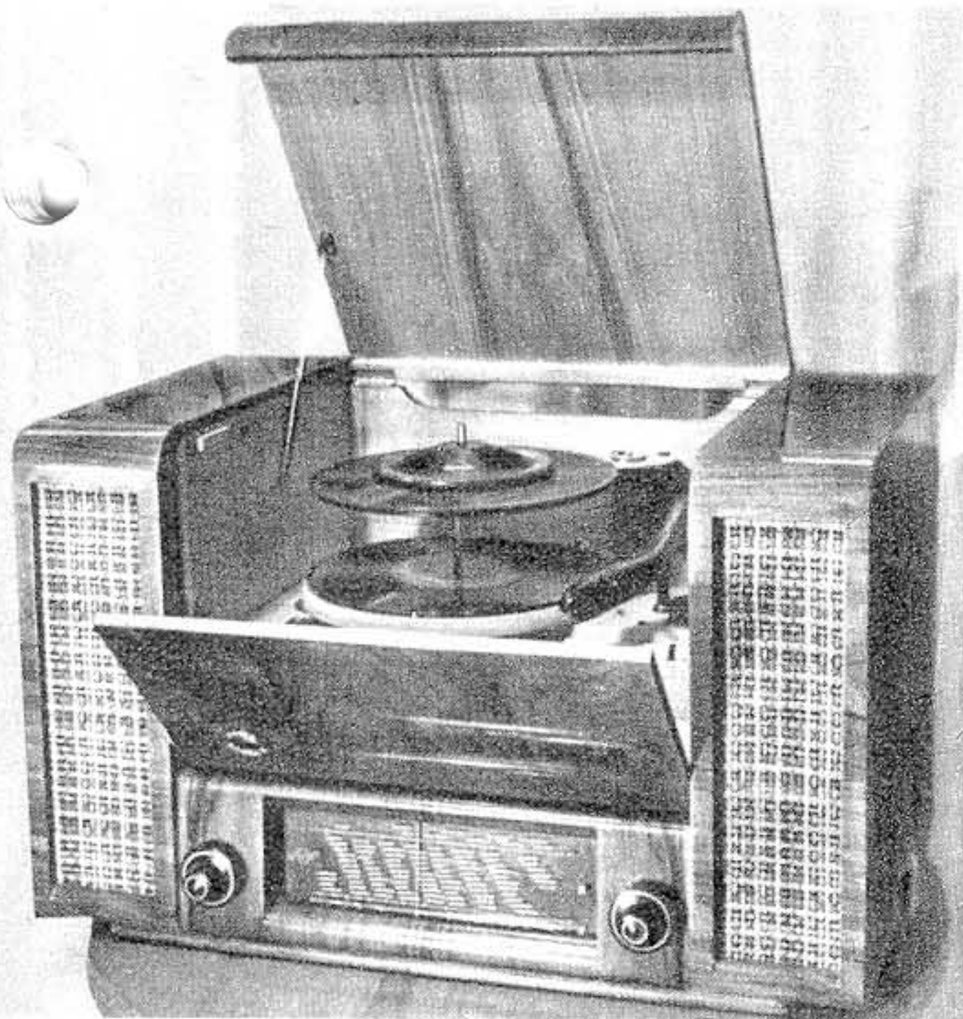
Rema-Fonosuper „Symphonie“ mit einem 10-Plattenwechsler der Firma Hummel & Seipfius, Dresden, ein 10-(10-)Kreis-AM/FM-Super. In dem Gerät sind die neuen Gnom-Röhren von RFT verwendet. UKW-Teil mit HF-Vorröhre und eine KW-Bandspreizung
